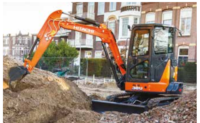
Den korte bakre svingradiusen gjør ZX38U-6 ideell for arbeid på steder med begrenset plass.
