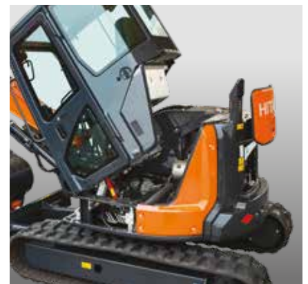
Det vipbare gulvet gir enkel tilgang til motoren og styreventilen.
