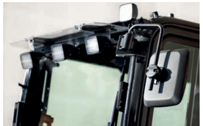
Nye plasseringer av bom- og førerhuslys øker sikten under krevende forhold.
