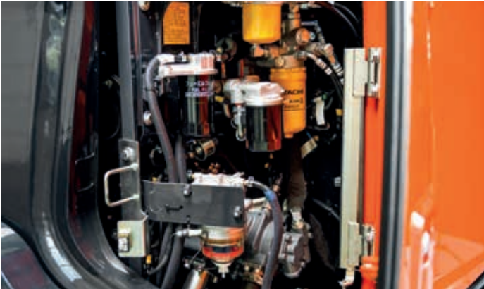
Alle filtrene er bekvemt plassert i ett rom.
